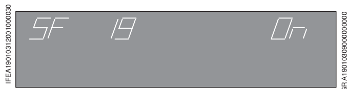
Рис. 23 SF 19 : Контроль длины листа вкл./выкл.
