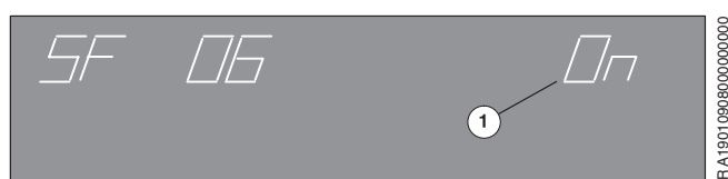
Рис. 10 Специальная функция SF 06: подвести держатель перфорационного ножа к печатному цилиндру
