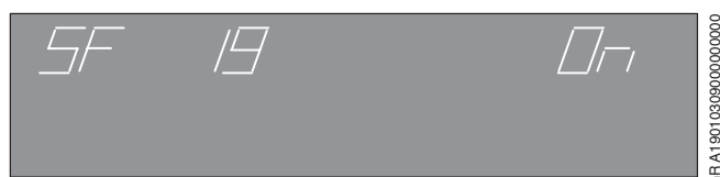
Рис. 22 SF 19: Контроль длины листа включен
